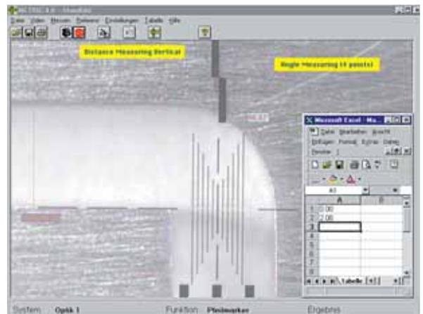
Zusatzrüstungen wie Videosystem, PC-Anschluss (Framegrabber), Optokabel und Mess-Software ermöglichen augenschonendes und ergonomisches Arbeiten, sowie Dokumentation und Bildauswertung
